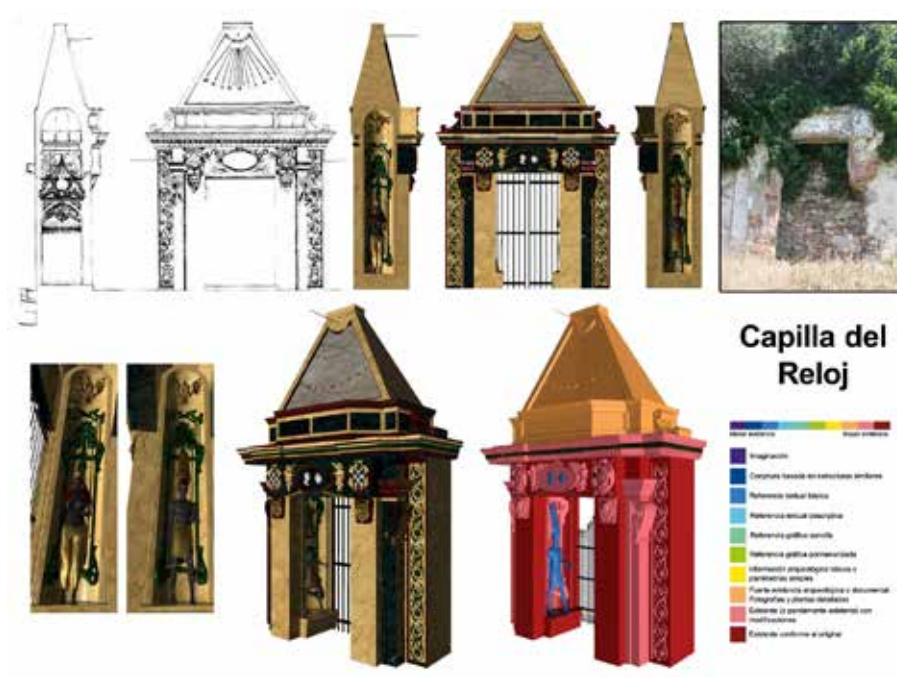
Fig. 3. Reconstrucción en 3D e infografía de la Capilla del Reloj realizada por la autora a partir de la sección de Alfonso Jiménez Martín (1984), de fotografías de la autora y de las descripciones de las principales fuentes textuales y descriptivas de La Abadía: B. de Villava, F. Lope de Vega y A. Ponz.
