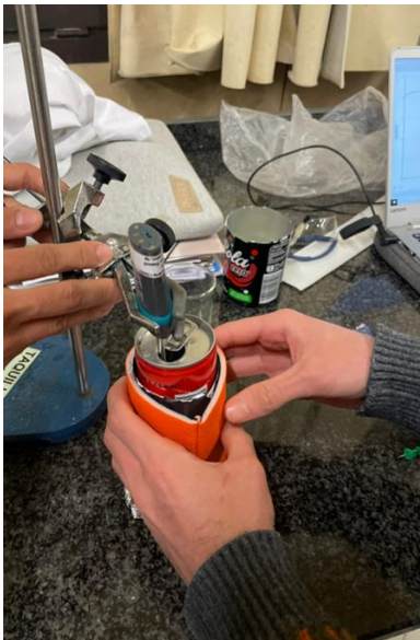
FIGURA 3. a) ejemplo del diseño final, con el aislante térmico en la lata más ancha, y el sensor digital de temperatura; b) curva de temperatura donde se aprecia la bajada de temperatura de la bebida respecto al tiempo transcurrido
