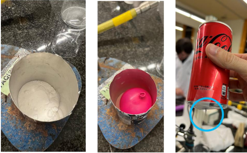
FIGURA 3. a) ejemplo del diseño final, con el aislante térmico en la lata más ancha, y el sensor digital de temperatura; b) curva de temperatura donde se aprecia la bajada de temperatura de la bebida respecto al tiempo transcurrido
