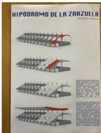
FIGURA 11. Principales secciones y detalles de trabajo de la zona de cubierta realizados por los alumnos.
