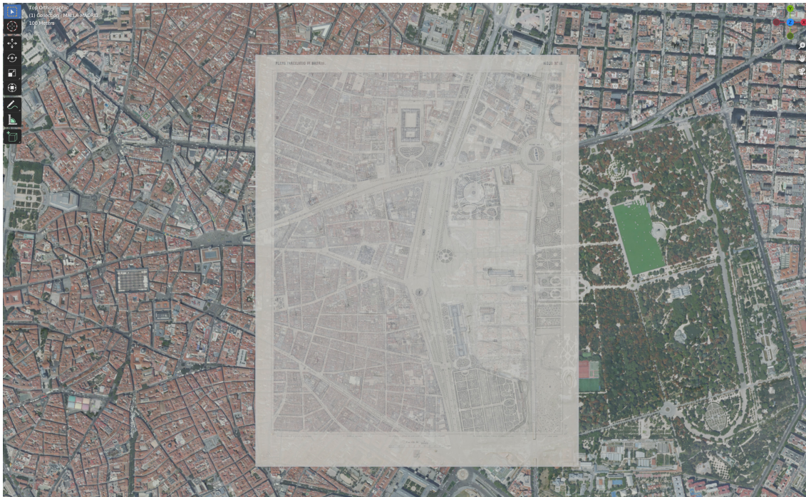
Fig. 17. Captura del proceso de trabajo en Blender 3.4.1. Superposición de la hoja 11 del plano de Carlos Ibáñez Íbero sobre el MDT de Madrid previamente texturizado con una ortofoto de máxima actualidad del PNOA.
