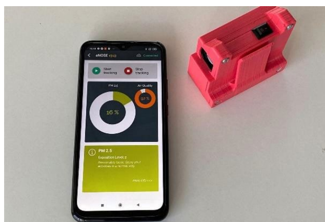
Figura 5. Equipo de monitorización de calidad del aire y teléfono móvil con el índice de calidad del aire.
