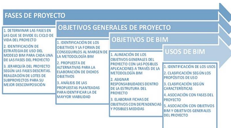
Figura 1: Proceso simplificado para clasificar objetivos y usos. Fuente. Guía para la elaboración del Plan de Ejecución BIM, esBIM.
