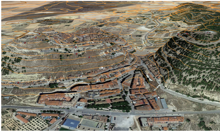
Figura 7. Superposición de las curvas de nivel en modelado 3d de Google Earth
