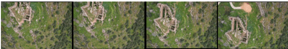
Figura 3. Ejemplo de superposición de fotografías del 75%, en un vuelo con dron, en el Castillo de Miraflores. Piedrabuena (Ciudad Real)
