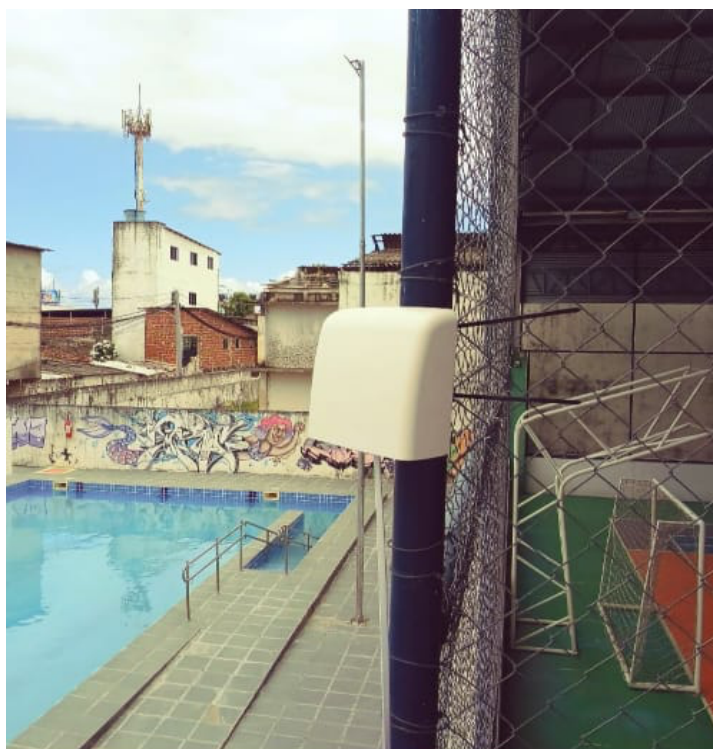
Figura 2. Estação de monitoramento da qualidade do ar e variáveis climáticas instalada no Compaz Dom Helder, área central da Cidade do Recife, 2024.
