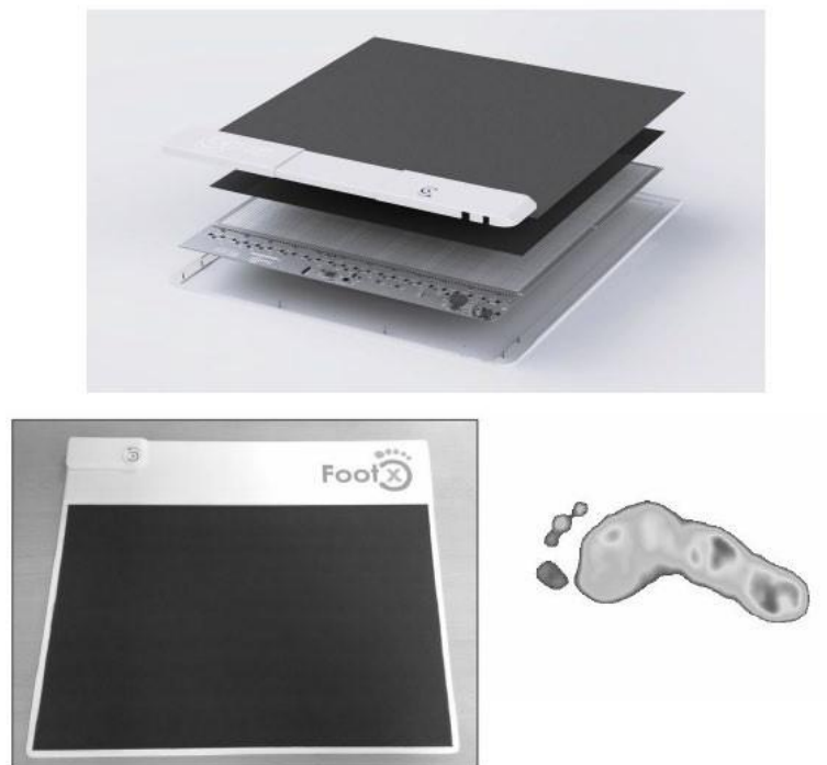
Figura 2. Arriba: Despiece del prototipo de Plataforma de Baropodometría. Abajo Izq.: Primer prototipo de Plataforma. Abajo Der.: Distribución de presiones en la pisada registrada con el prototipo de Plataforma.
