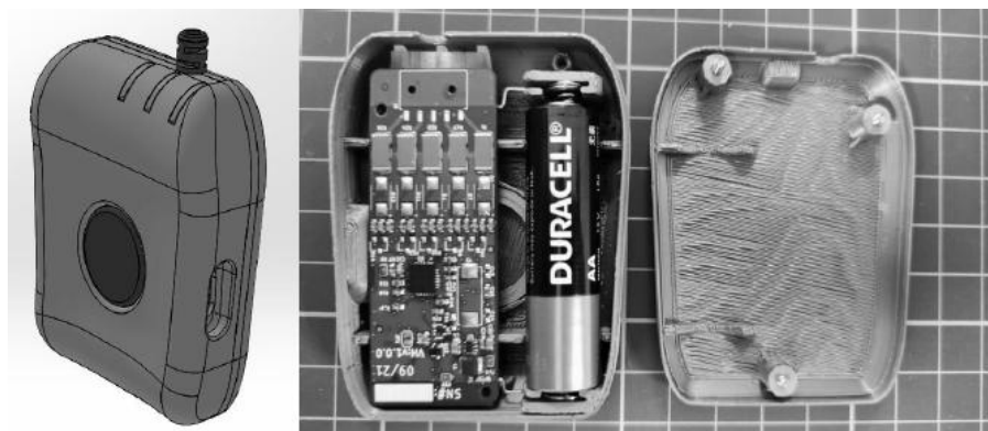
Figura 4. Izq.: Modelado de carcasa de dispositivo Holter. Der.: Prototipo de dispositivo Holter incluyendo electrónica y carcasa impresa en 3D.
