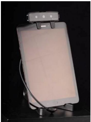
FIGURA 3. Tablet Galaxy Tab S3 (Samsung), cámara Bellus 3D con puerto USB visible en la parte inferior y soporte para Tablet.
