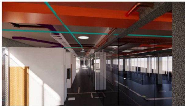
Fig. 2 Edificio de oficinas. Vista interior de interferencias de instalaciones en cielorraso y piso.
