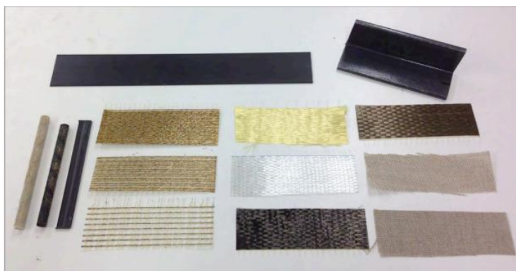
Figura 4 Diferentes tipos de materiales FRP. [12]
