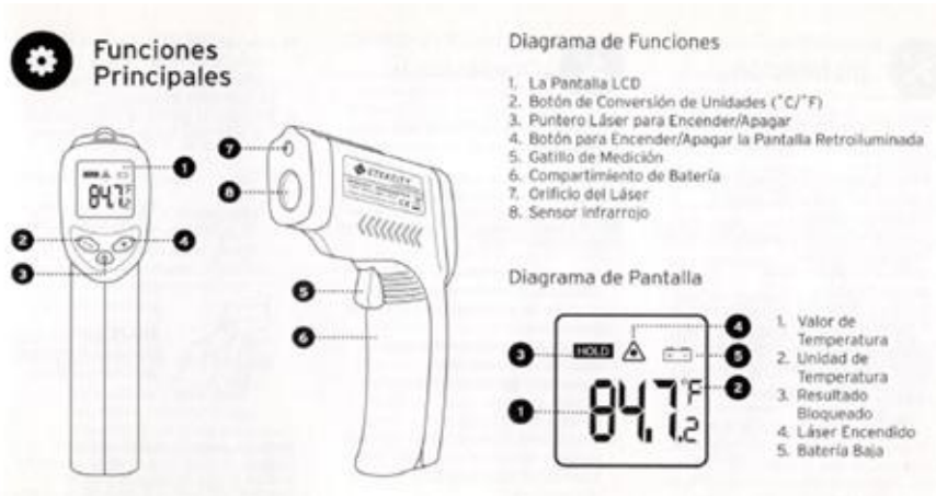
Figura 13: Características termómetro láser. Fuente: Etekcity
