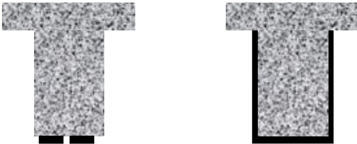
Figura 5 Materiales compuestos en vigas, Izquierda en tiras y derecha en forma de textil.
