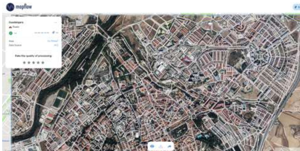
Figura 4. Identificación automática de las vías urbanas de la ciudad de Guadalajara con la herramienta MapFlow. Las líneas blancas representan el entramado urbano de la ciudad y han sido generadas de forma automática por la aplicación. Se podrían, por ejemplo, extraer y mostrar sobre un fondo oscuro para explicar a los estudiantes los diferentes planos urbanos, que se pueden apreciar en los distintos barrios de la ciudad
