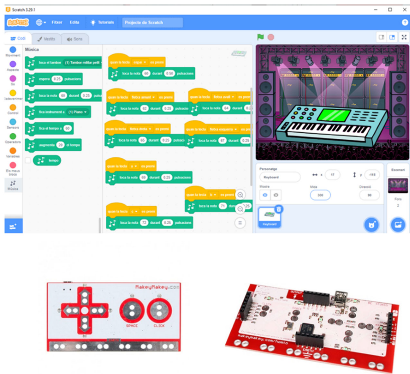
FIGURA 3. Scratch con la secuencia de configuración diseñada para esta experiencia (imagen superior) y dispositivo Makey Makey (imagen inferior)
