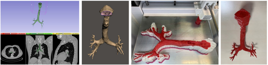
FIGURA 3. Flujo de trabajo de la reproducción de una tráquea con impresión 3D para practicar bronoscopias: (de izquierda a derecha) captura de pantalla de la segmentación digital en 3D Slicer, imagen del exportado en STL de la tráquea digital, tráquea imprimiéndose en 3D en TPU flexible rojo y PVA soluble, imagen de la tráquea final para su uso docente.
