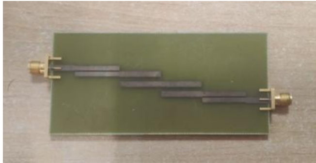
Figura 6. Filtro paso banda con líneas acopladas implementado
