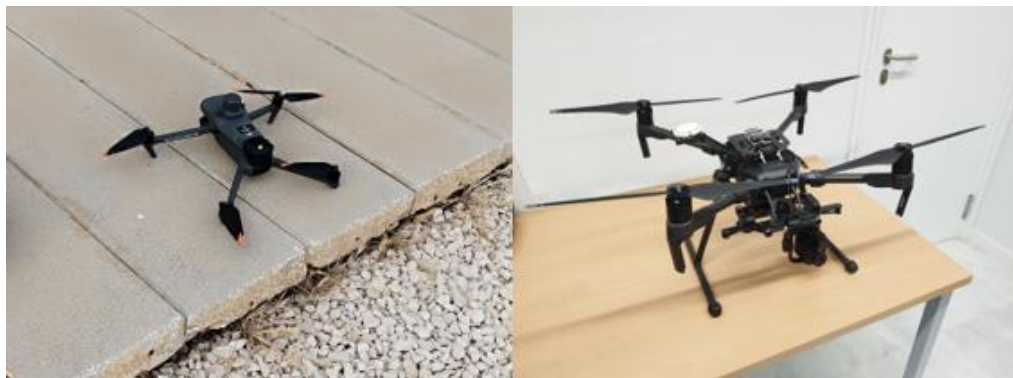
Figura 2. Drones utilizados en el proyecto (UJA): (a) Mavic DJI3T; (b) Matrice 300 RTK
