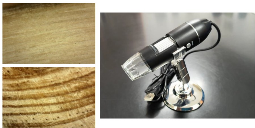
FIGURA 6. Lupa conectada al ordenador por USB para la observación en tiempo real de estructuras vegetales.
