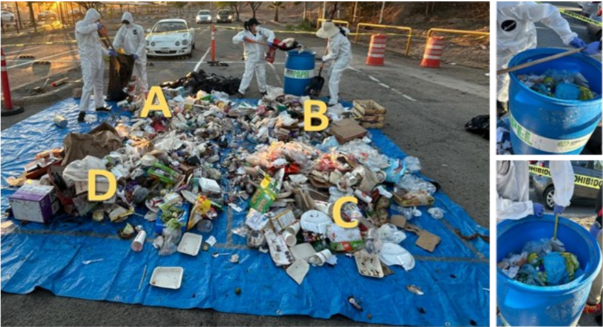
FIGURA 3. Obtención del peso volumétrico In Situ
